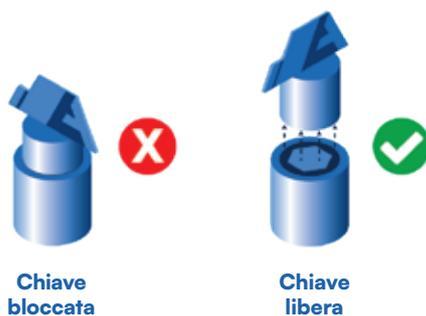
Attraverso la combinazione delle prime due posizioni (**Aperto — Chiuso**) è possibile definire in maniera univoca la posizione del singolo elemento ed attraverso la combinazione dei due stati (**Chiave bloccata — Chiave libera**) attivare l'interconnessione con gli altri elementi del sistema.
